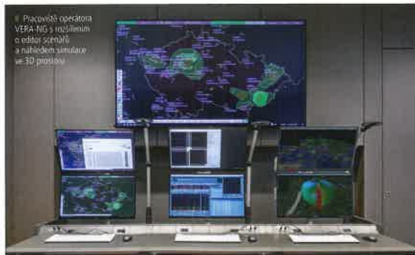
Náhled simulované situace ve 3D prostoru se zobrazením vyzařovacích charakteristik antén radarů
