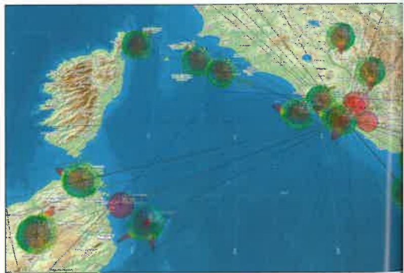
Náhled simulované situace ve 3D prostoru se zobrazením vyzařovacích charakteristik antén radarů
